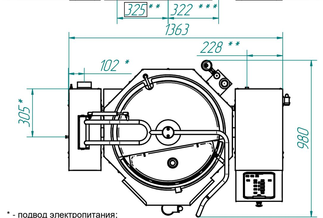
Котлы пищеварочные электрические с функциями опрокидывания, перемешивания и охлаждения типа КПЭМ предназначены для приготовления бульонов, соусов, десертов, супов и различных вторых и третьих блюд. Котлы используются на предприятиях общественного питания, столовых производственных предприятий и на производствах различных продуктов питания, как самостоятельно так и в составе технологических линий.
